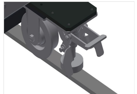
行走单元 带凸缘滚轮和驻车制动器的行走装置
