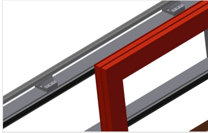
倚靠面 VE 3000/60 带塑料滑条的背面倚靠面
