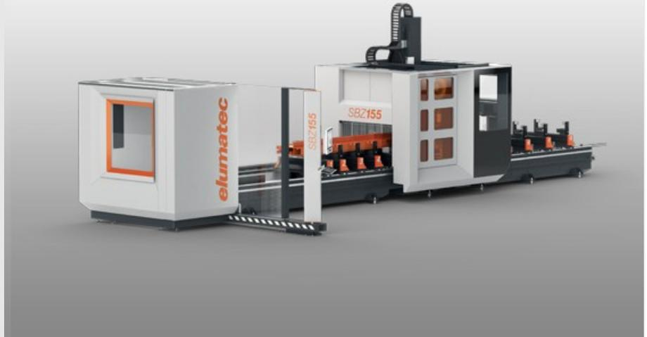
能够满足最高要求的5轴型材加工中心，首次采用龙门式设计构造：作为elumatec全新的顶级产品，SBZ 155型材加工中心将无以伦比的性能参数与开创性的设计合二为一。紧凑、灵活、快速：SBZ 155是铝合金、薄壁钢型材全自动CNC加工中心的里程碑、特别是其6面加工功能以及节省空间的可选配龙门驱动器。由于SBZ 155缩短了刀具换装时间，因此能够保证理想的加工循环，并且该款机床还具备极高的灵活性，因此金属加工以及工业领域的用户将会从中受益。大尺寸随动刀库可装备14个标准刀具。依据不同的配置，还可配备最多六个特殊刀具以及两个直径为200或550 mm的锯片。龙门式设计和2个加工区域能够容纳和通过横截面最大高达1,000 x 380 mm的型材以及在穿梭式加工中的灵活作业。依据elumatec客户的单独要求，SBZ 155还可增加为数众多的选配项目。从双侧自动长度测量到二维码扫描，不会让您的任何愿望落空。此外，这一全能型设备也同样可以使用eluCloud，因此符合工业4.0的要求。
