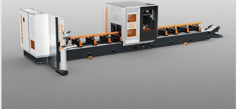
SBZ 145 专为满足金属结构和工业用途的要求而设计、配备 5 个加工轴、加工范围为 560 mm x 350 mm x 7500 mm。配备了一个自主夹紧轴和一个大尺寸刀库、可存放铣刀、钻头、丝锥和锯片。SBZ 145 具有多种加工选项、可从型材棒进行加工和切割、或者可以选择穿梭式加工 (2x 3,250 mm) 处理预切割的单个零件。
