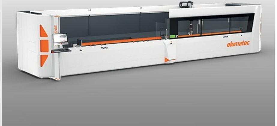
节省时间，节省空间，降低成本：SBZ 125/85型材加工中心为全封闭舱式机床，有效长度达八米，具有五个轴，其动态穿梭式加工可取代两台小型机床。在广受好评的SBZ 122/75基础上进一步开发的过程中，elumatec充分考虑了客户的反馈意见，将人体工学设计、可触及性以及备料时间进行了优化。在加工铝合金、塑料以及薄壁钢型材时，该新款机型更加经济，更加合理。
