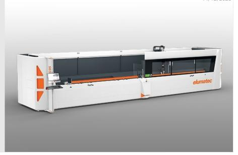
节省时间,节省空间,降低成本: SBZ 125/85型材加工中心为全封闭舱式机床,有效长度达八米,具有五个轴,其动态穿梭式加工可取代两台小型机床。在广受好评的SBZ 122/75基础上进一步开发的过程中,elumatec充分考虑了客户的反馈意见,将人体工学设计、可触及性以及备料时间进行了优化。在加工铝合金、塑料以及薄壁钢型材时,该新款机型更加经济,更加合理。
