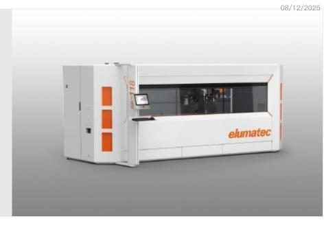
SBZ 118是一款三轴型材加工中心,可选择五面加工,使用方便,占地面积最小,扩大了它扩大了elumatec的入门级产品范围,用于铝、PVC和薄壁钢型材的自动化数控加工。它的加工长度为这款多功能、功能强大的机型是目前elumatec系列中最紧凑的数控机床。
