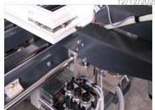
**拧螺丝单元** 可移动且由气动调节高度的螺钉紧固装置
