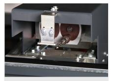
角传动器钻孔装置 角传动器钻孔装置配备有可调节的双轴钻头,气动高 度调节装置,并且带有用于左右钻孔位置的止动器
