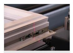
激光单元 (选配) 用于螺栓位置的激光
