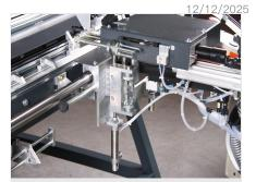
带批头和手动送料斗的螺丝刀 带批头和手动送料斗的螺丝刀,用于第二种螺长度的
