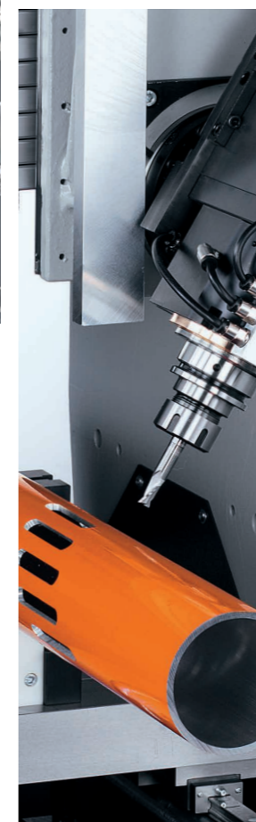
Il centro di lavoro a 4 assi SBZ 141 Il nuovo modello di punta della serie SBZ 14x presenta adesso una base macchina migliorata e una regolazione del serrapezzi autonoma.
