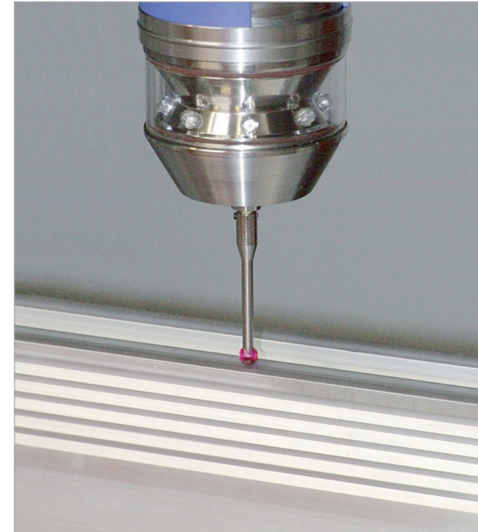
3D uç şile ölçüm. Mevcut profil toleranslarında işlemler bu şekilde hassas bir şekilde konumlandırılabilir.
