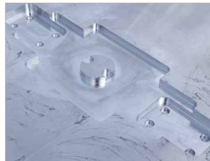
Funkcia „Odstrániť voľné tvary“ vypočíta úplne automaticky všetky dráhy frézovania, ktoré sú potrebné na celoplošné ubratie uvedeného voľného tvaru. Pri odstránení sa dajú obísť vopred definované „ostrovčeky“.
