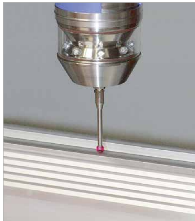
Meranie 3D snímačom. Tak sa obrábania dajú presne napolohovať aj pri existujúcich toleranciách profilov.
