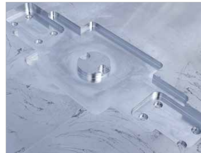
Функция „Очистка свободных форм“ автоматически рассчитывает все дорожки фрезерования, необходимые для снятия материала по всей площади заданной свободной формы. При очистке можно обойти предварительно заданные „островки“.
