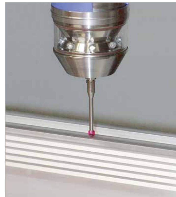
Измерение с помощью трехмерного щупа. С ним становится возможным точное позиционирование обработок даже при наличии допусков профиля.
