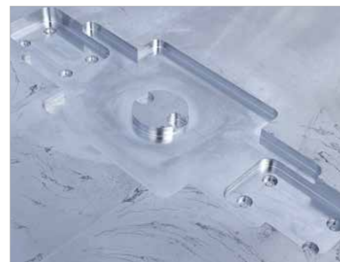
La funzione “Eliminazione di una forma libera” calcola adesso automaticamente tutti i binari di fresatura necessari per l'eliminazione su tutta la superficie della forma libera indicata. Nell'operazione di eliminazione si può girare intorno alle “isole” predefinite.
