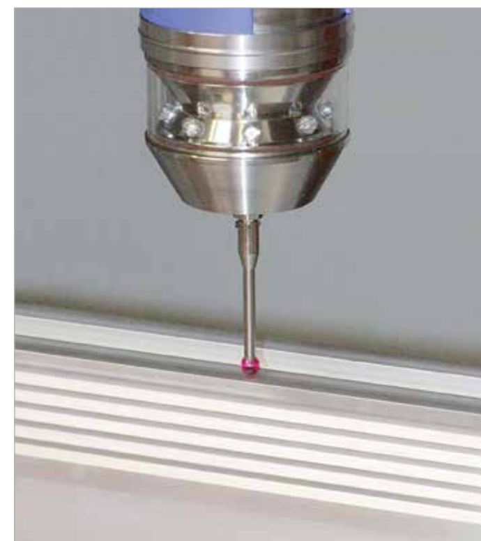
Misurazione con sensore 3D. In questo modo si possono posizionare con esattezza anche le lavorazioni con le tolleranze esistenti del profilo.
