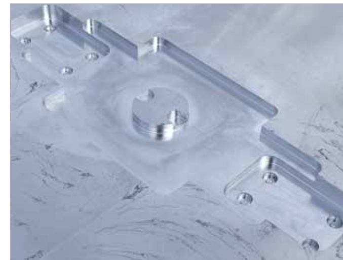
Funkcija „Prenesi slobodni oblik“ potpuno automatski izračunava sve staze rezanja koje su potrebne za prijenos zadanog slobodnog oblika na punoj površini. Prilikom prijenosa mogu se zaobilaziti prethodno definirani „Otoci“.
