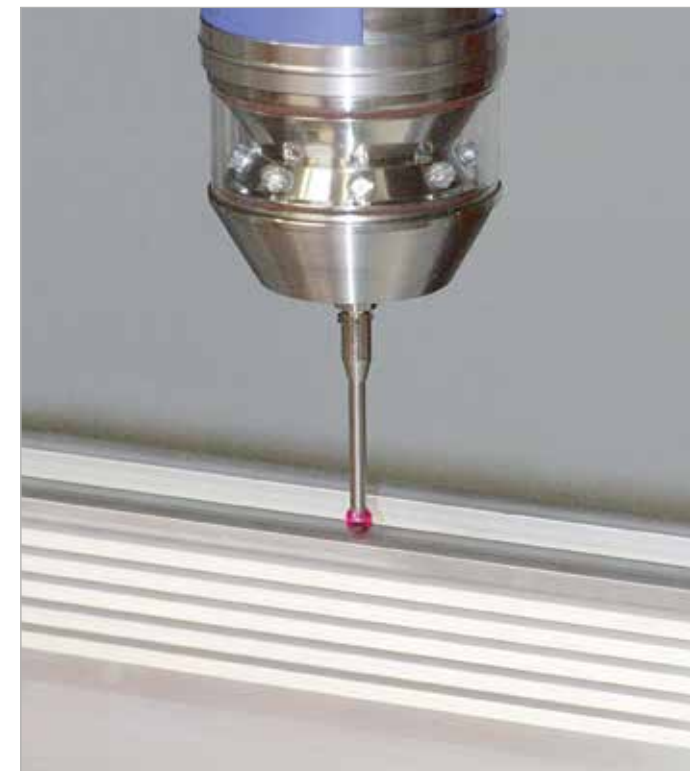
Mjerenje 3D tipkom. Omogućuje precizno pozicioniranje obrada i uz postojeće tolerancije profila.
