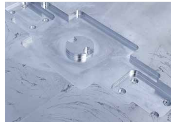
La fonction « Enlèvement de formes libres » calcule automatiquement les trajectoires de fraisage nécessaires pour l'enlèvement de la forme libre indiquée sur toute la surface. Il est possible de contourner des « ilots » prédéfinis lors des opérations d'enlèvement.
