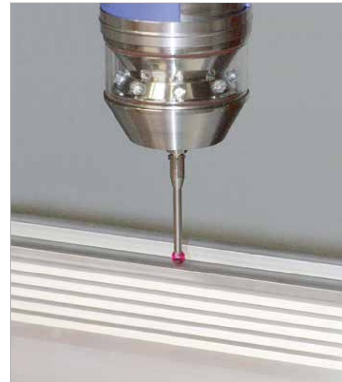
Mesurer à l'aide du bouton 3D. Il est possible ainsi de réaliser des positionnements précis des usinages avec les tolérances de profilés présentes.
