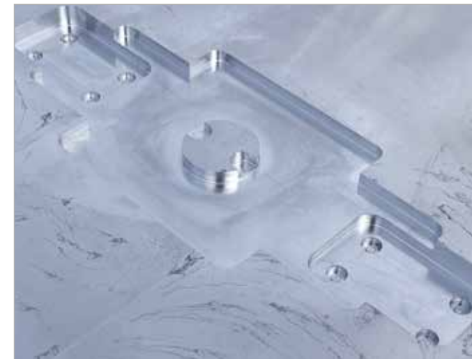
Die Funktion „Freiform ausräumen“ berechnet vollautomatisch alle Fräsbahnen, die für den vollflächigen Abtrag der angegebenen Freiform notwendig sind. Beim Ausräumen können vorher definierte „Inseln“ umfahren werden.
