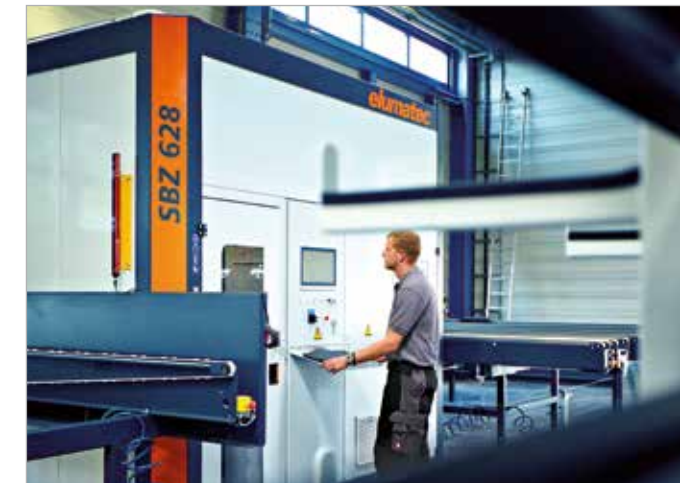
Stabbearbeitungszentrum SBZ 628 Foto: Dirk Dießel
