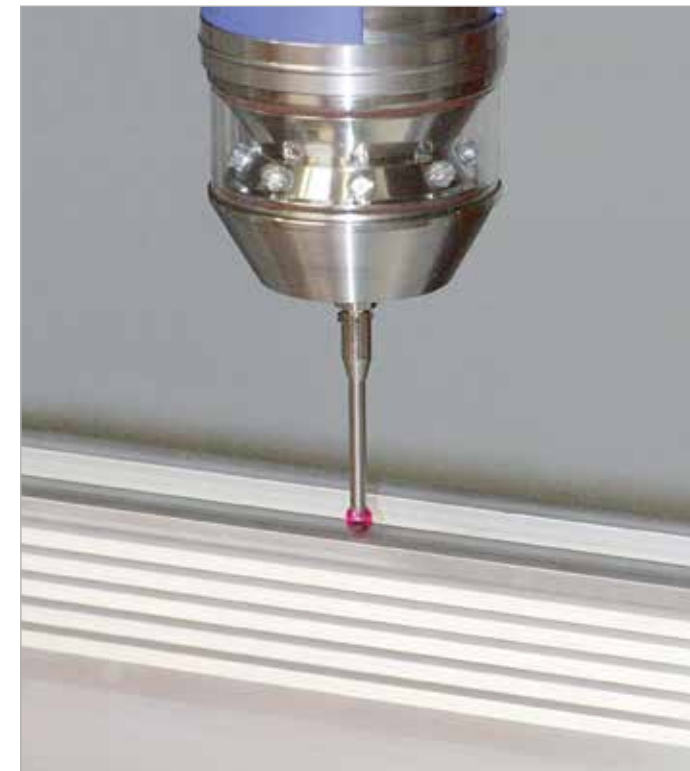
Messen mit 3D-Taster. So lassen sich auch bei vorhandenen Profiltoleranzen Bearbeitungen exakt positionieren.
