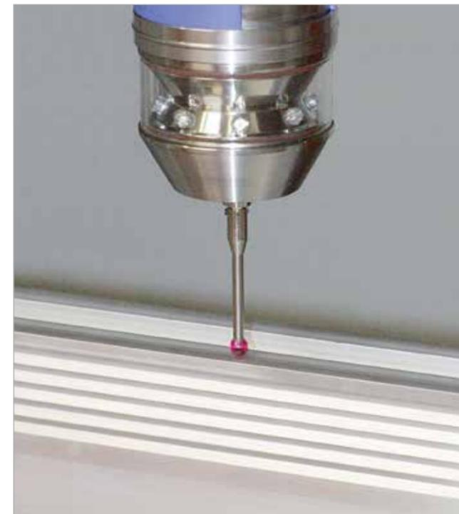
Medição com sensores 3D. Desse modo é também possível situar com precisão as operações de usinagem levando em conta as tolerâncias de perfis existentes.
