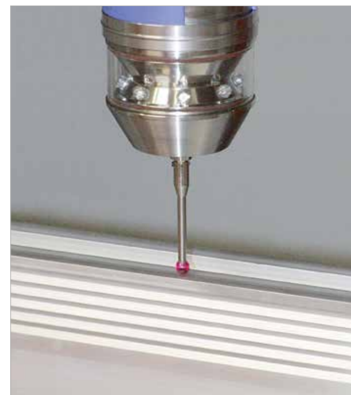
Mérés 3D-letapogatóval. Ezzel a megmunkálások helyzete még meglévő profiltűrések esetén is rendkívül pontosan meghatározható.
