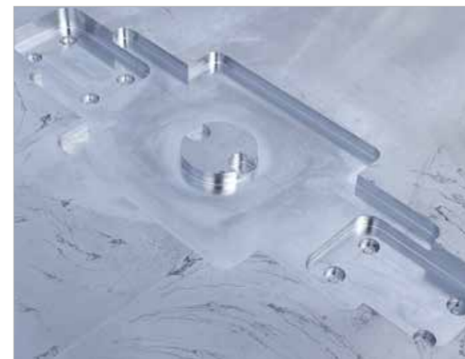
A „szabadforma kiürítés” funkció teljesen automatikusan kiszámítja a marási pályákat, amelyek az előírt szabadforma teljes felületén történő eltávolításához szükségesek. A kiürítésnél az előzőleg meghatározott „szigetek” kikerülhetnek.
