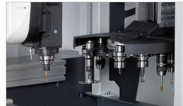
Поворотный магазин с 12-позиционным устройством смены инструментов
