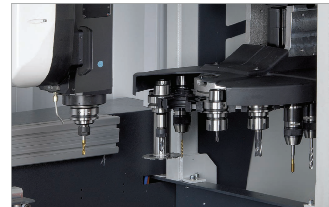
Forgó tár 12-szeres szerszámcsereivel
