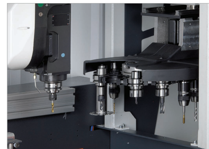
Magasin rotatif à changeur de 12 outils
