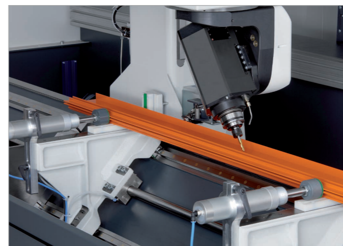
Tête d'usinage à axes A et C
