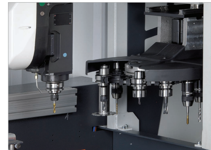
Otočný zásobník s 12nás. výměníkem nástrojů
