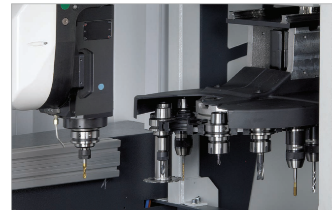
Въртящ се магазин с устройство за смяна на инструмента с 12 гнезда
