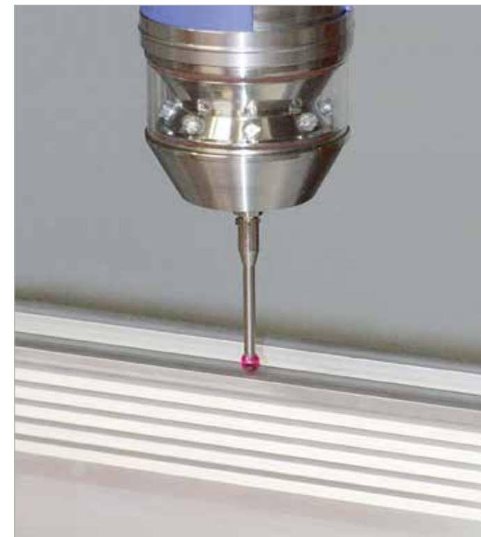
Merenje pomoću 3D tastera. Tako čak i kod postojećih tolerancija profila, obrade mogu egzaktno da se pozicioniraju.
