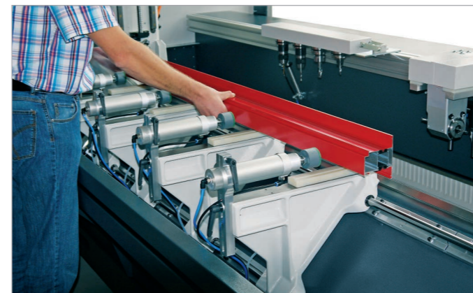
Base macchina, nella moderna "versione inclinata"
