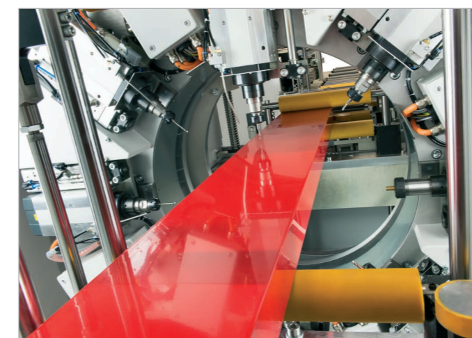
Modulo di rotazione innovativo, dotato di otto mandrini
