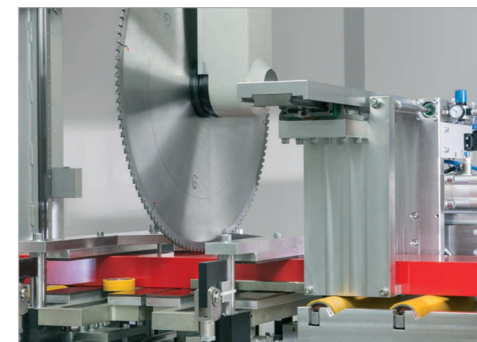
Lama della sega orientabile in continuo
