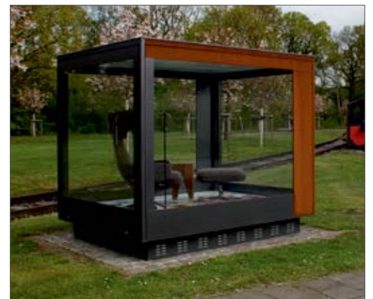
Индивидуальная бульварная витрина с элементами из погодостойкой кортеновской стали.
