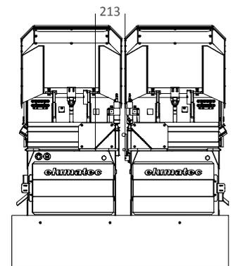
Dimension minimale pour une coupe à 45° avec butée de dimension courte sur l'unité mobile : 213 mm
