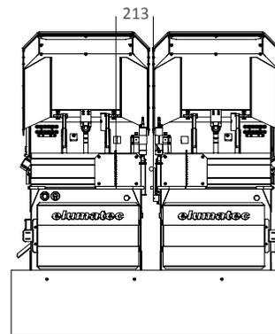
Dimension minimale pour une coupe à 90° avec butée de dimension courte sur l'unité mobile : 213 mm
