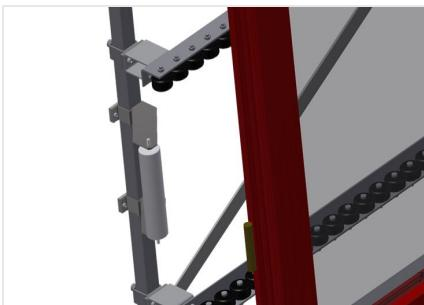
**Дополнительные роликовые полотна**
