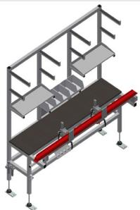
**Монтажный стол для сборки дверных профилей ТМТ 2000**
