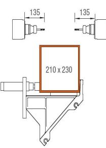
**Область обработки по оси Y и Z**
