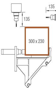
**Область обработки по оси Y и Z**
