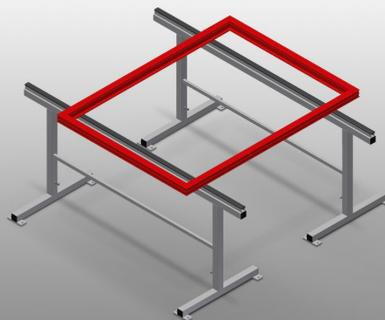
Монтажные стойки для работы с большими оконными элементами
