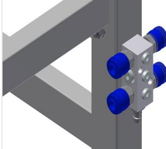
**Пневматическое соединение на 4 штуцера**
