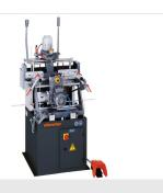
Двухшпиндельный копировальнофрезерный станок КF 78/23
