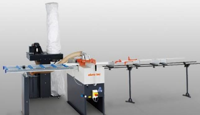
Пила для V-образных резов оборудована 2 пильными дисками для распилов под углом 45°
