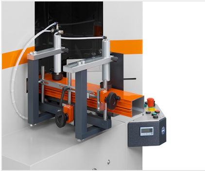
Пила для торцевой обработки профиля AKS V-550
