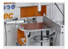
Фрезерный станок для фрезерования торцов AF 223/01
