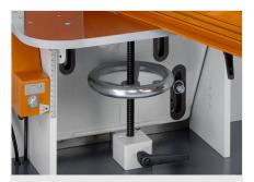
Фрезерный станок для фрезерования торцов AF 223/01
