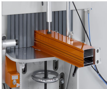
Фрезерный станок для фрезерования торцов AF 223/01
