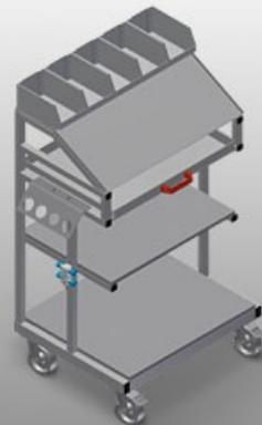
Carro para acessórios, para ferramentas e peças pequenas para a estação de montagem
