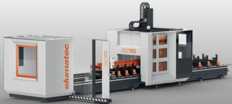
Maquinação de perfis de 5 eixos para os requisitos mais elevados, pela primeira vez na conceção de portais: Sendo um novo modelo de topo elumatec, o centro de maquinação de barras SBZ 155 combina parâmetros de desempenho anteriormente inatingidos com um design inovador.
