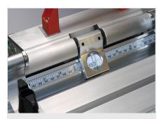
Sistema de batente e medição MMS 100
