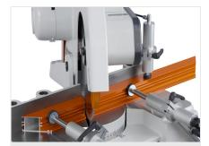
Máquina de corte angular MGS 72/30
