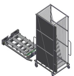
**Estação de elevação de vidro GHS 15 + Carro de compartimentos para vidro GFW 15**
