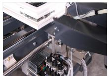
**aparafusamento**Unidade de aparafusamento, móvel, com ajuste pneumático em altura
