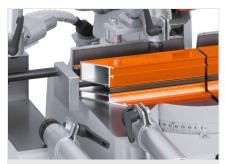
Máquina de corte de duas cabeças angulares DG 79
