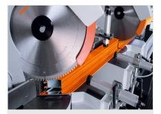
Máquina de corte de duas cabeças angulares DG 79
