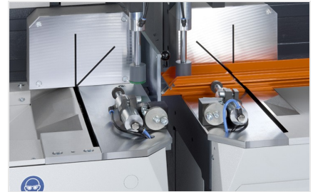
04. Máquina de corte de duas cabeças angulares DG 142 XL
