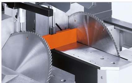
02. Máquina de corte de duas cabeças angulares DG 142 XL
