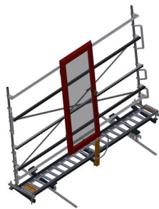
Pionowy podajnik rolkowy z układem jezdnym i obrotowym VR 4003 DF
