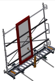
Pionowy podajnik rolkowy z układem jezdnym i obrotowym VR 3003 DF
