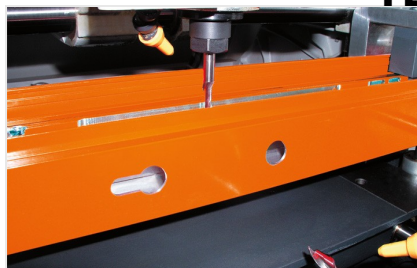
Dwuwrzecionowa frezarko-kopiarka KF 78/23
