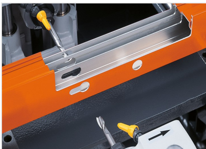
Trójwrzecionowa frezarko- kopiarka KF 178/10
