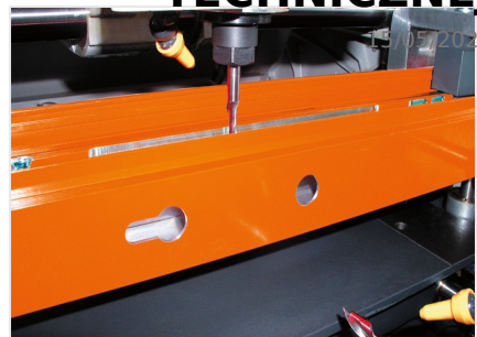
Trójwrzecionowa frezarko- kopiarka KF 178/10
