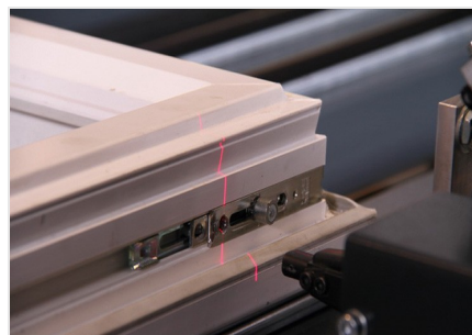
Jednostka laserowa (opcja) Laser do pozycji śruby
