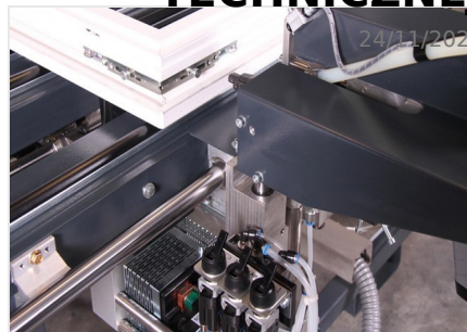
Jednostka wkrętarska Przełączna jednostka wkrętarska z pneumatycznie regulowaną wysokością.
