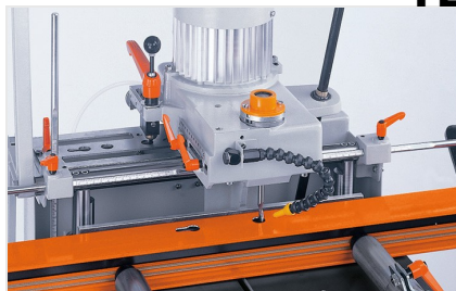
Jednowrzecionowa frezarko-kopiarka AS 70/44
