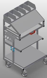
Carrello accessori per utensili e minuteria per la stazione di montaggio
